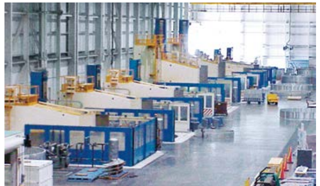
Boeing, Decatur, Alabama, USA N.8 Tornos verticales fresadora, modelo (AS 65 TM) N.8 Tornos verticais fresadoras, modelo (AS 65 TM)
